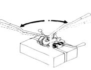
Quetschzange öffnen bis die Quetschhülse fest sitzt und das Band abgetrennt wurde.
