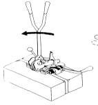
7 Quetschzange über der Hülse positionieren.
